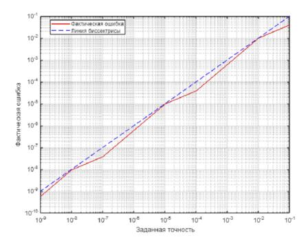
Рис. 4: График зависимости фактической ошибки от заданной точности
