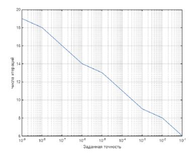
Рис. 2: График зависимости числа итераций от заданной точности
