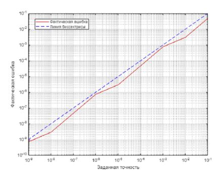
Рис. 1: График зависимости фактической ошибки от заданной точности
