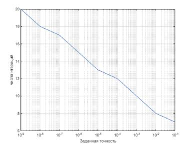
Рис. 5: График зависимости числа итераций от заданной точности
